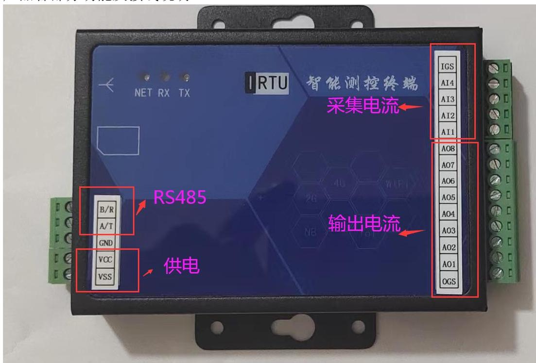
1. 输入电源端子： VCC 正极，VSS 负极 DC10-30V 供电。
