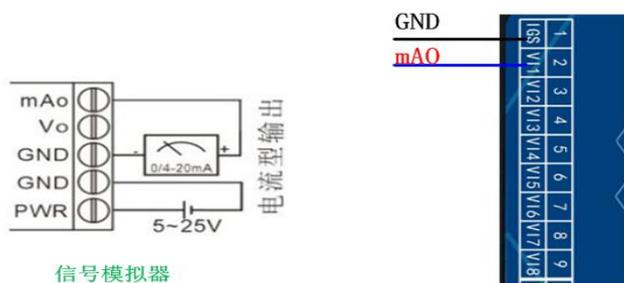
(2) 两线制传感器信号接入模块输入端：两线制传感器就是外部给他供电及输出 4-20MA 信号形成回路测得 4-20MA 信号，下图中表示接入 7328A 第一路采集端子。7328A 自身端子并不输出 24V，
