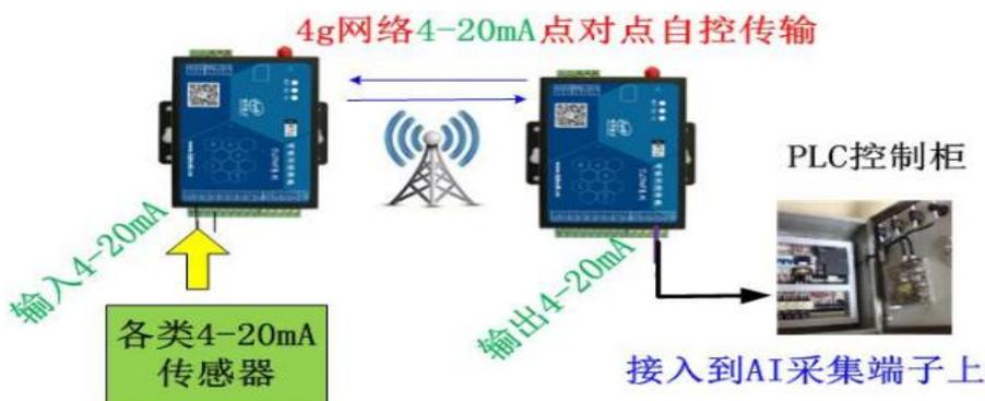
2、新版应用示意图：除了 4-20MA 无线自传自控之外，手机和电脑可以监测数据或控制
