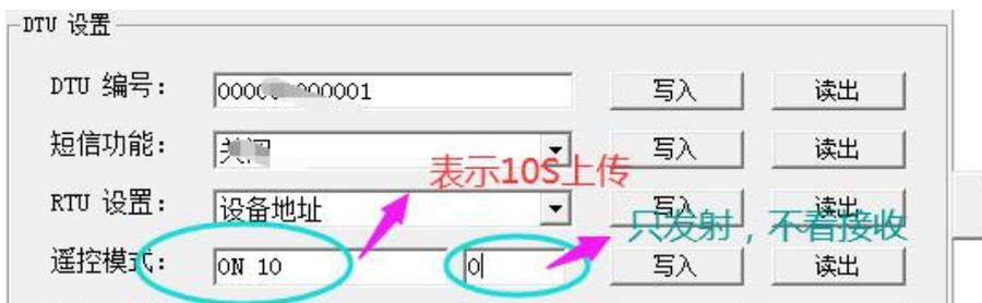
2) 新版参数：设置时关注服务器参数及发布号和订阅号，发射端的模块和接收端的模块的发布号和订阅号互对则为双向，单发布和单订阅为单向传输。
